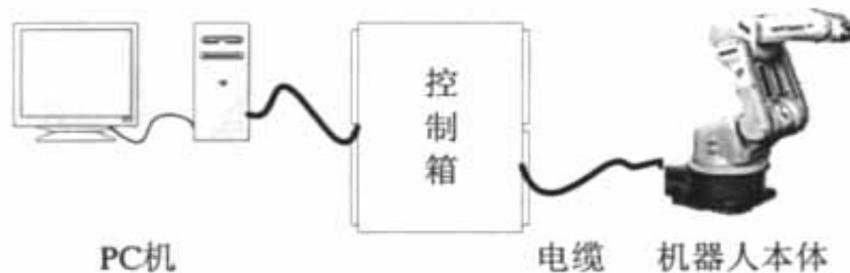
图 2.1 机器人系统组成
