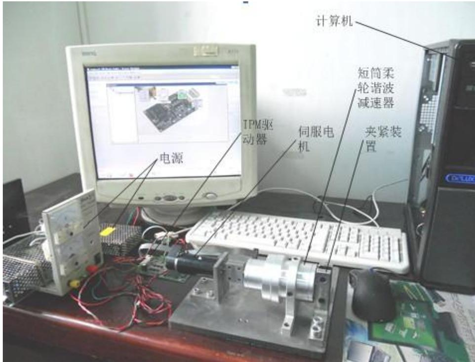
图 5-1 传动刚度实验测试装置
