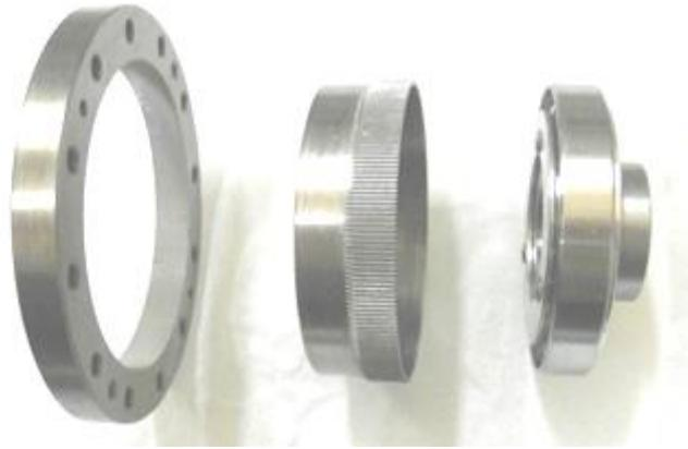
图 4-9 1/4 比例短筒柔轮谐波减速器三元件
