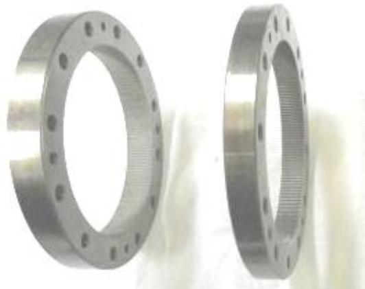
图 4-8 柔轮长径比为 1/2 比例和 1/4 比例的对应具有 0.2° 倾角刚轮
